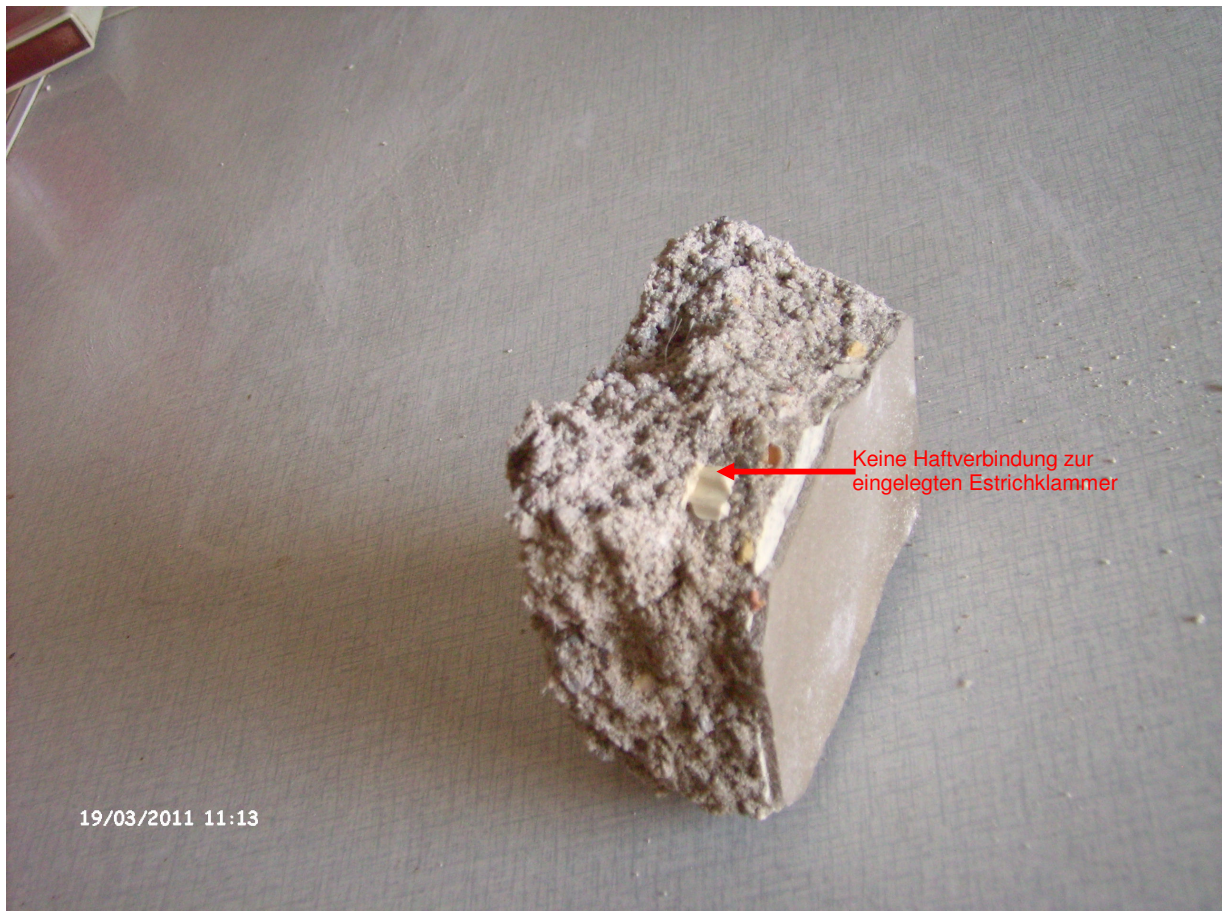
Bild 16: Klebeharz mit Abdruck der Estrichklammer ohne kraftschlüssige Verbindung!
